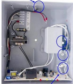
Orificios de Entrada/Salida de cables de **alto voltaje**:
