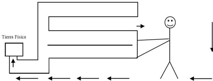
Si el equipo no cuenta con una buena tierra física, el retorno al individuo no será suficiente para impactarlo como lo requerimos y muy posiblemente penetrara el perímetro. La manera de evaluar si una tierra física es correcta, ya sea varilla de tierra o tubería de agua fría, se basa en realizar tres pruebas con un voltímetro, esto nos indicara si la tierra es operante.
