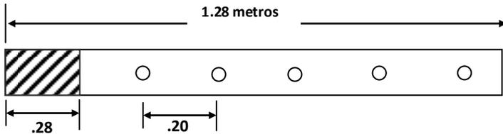
Se corta un tramo de tubo de 1.28 metros, se mide y se excluyen los 28 centímetros para el anclaje, y el resto se divide cada 20 centímetros para la colocación de aisladores, colocando una marca como señal.
